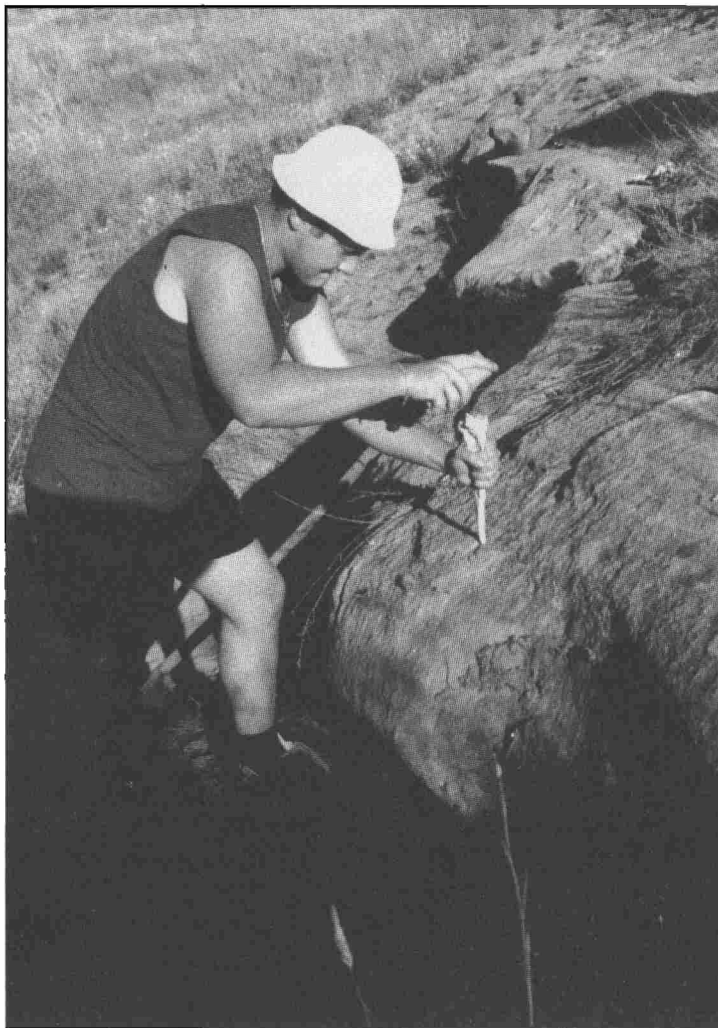
Рис. 9.13. Эксперимент по горной по- верхностной проходке в песчаниковой породе: работа ведется с помощью ка- менных молотов и костяных клиньев
