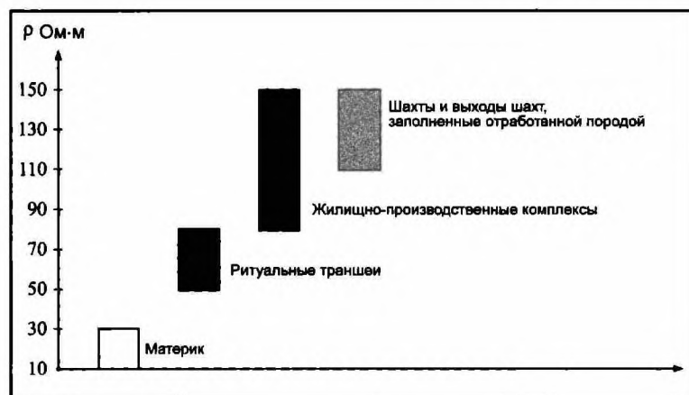
Рис. Пр.3.4. Поселение Горный. «Шкала сопротивлений» для функциональной интерпретации археологических объектов по геофизическим данным
