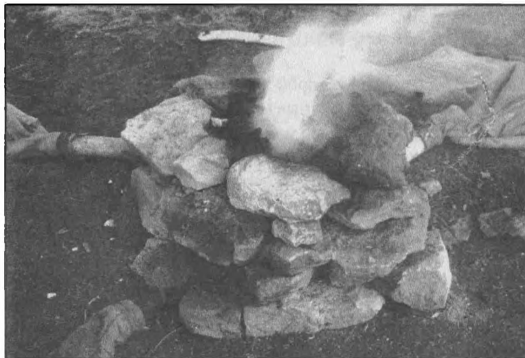
Рис. Пр.6.2. Печь для экспериментальной плавки с трехсторонним дутьем; вид сбоку (эксперимент 1998 г.)
