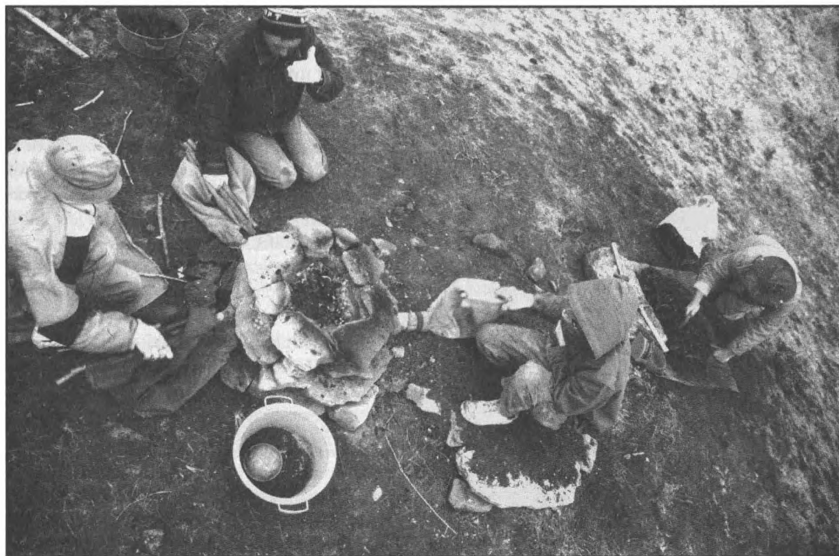
Рис. Пр.6.1. Печь для экспериментальной плавки с трехсторонним дутьем; вид сверху (эксперимент 1998 г.)
