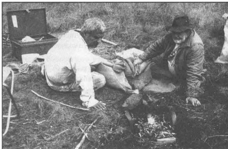
Рис. Пр.6.4. Плавка медных капель в тигле; для дутья используется изогнутое сопло с двумя мехами
